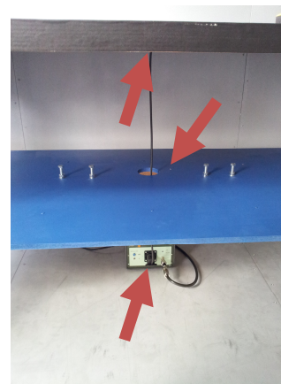
Figuur 1: Aansluiten voedingskabel op LISN
