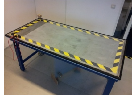
Figuur 1: ESD tafel met markeringen en plastic isolatiesheet
