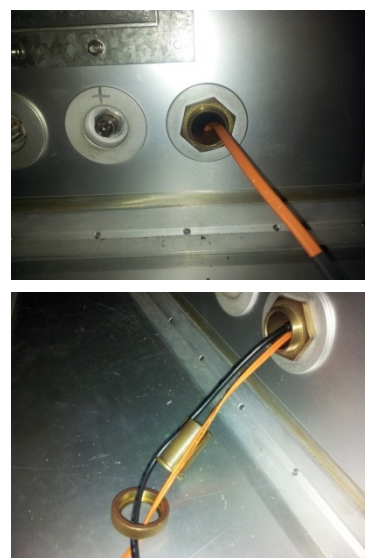
Figuur 3: geleiding van de kabels in de GTEM.
