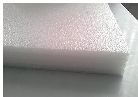
Figuur 2: polyethyleen isolator voor verhoging van VP_{EUT}
