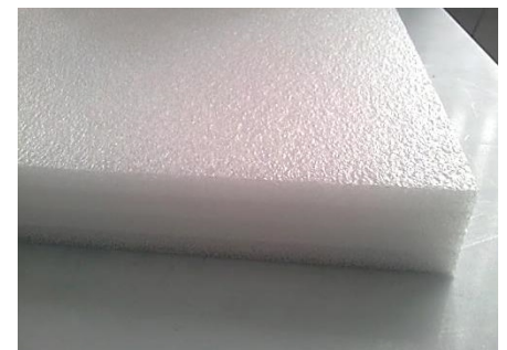
Figuur 2: polyethyleen isolator voor verhoging van VP_{EUT}
